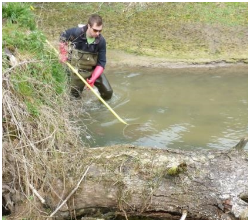
Elektrofischung in einem Fließgewässer zur Umsetzung der EU-WRRL
